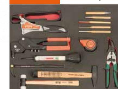
Martillos y botadores, tijera cortachapa, remachadora, flexómetro, palanca articulada, densímetro de baterías y llave de cinta
